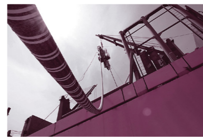
工場で作られたケーブルは、そのまま専用船に積み込まれて工事現場となる海に運ばれる。1本のケーブルが数十kmを超える長さになることも珍しくないため、トラックなどで運ぶことができない。そのため設備が工場にも船にも備わっている。専用のラインを使って、工場から少しずつケーブルを送り出し、クレーンを使って船内のターンテーブルに巻き取っていく。（写真提供/住友電気工業株式会社）
