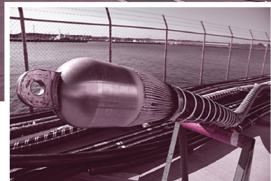
実証試験に使われた海底ケーブルのサンプル。試験のために定められた長さのケーブルを使い、先端には特別な金具が取り付けられている。
