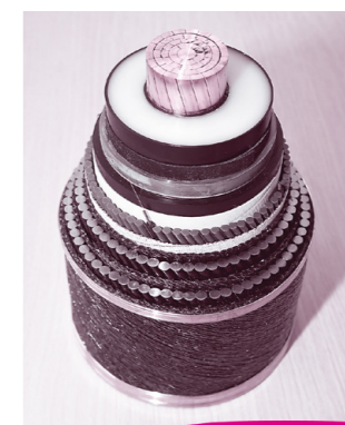
525kV 直流XLPEケーブルの内部のつくりがわかるようにしたカットモデル。全体の直径は約18cm。重さは1mにつき約70kgもあるよ。
