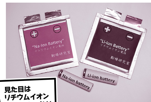
ナトリウムイオン電池とリチウムイオン電池の比較イメージ模型。リチウムイオン電池と基本的なしくみは同じなので、似たような形状・使い方ができる。
