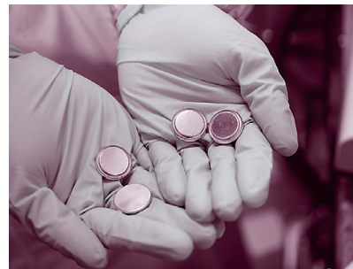
コイン型に組み上げられたナトリウムイオン電池。小さなコイン型電池で基本的な性能を調べ、今後の大型化などに適した材料を検討していく。
