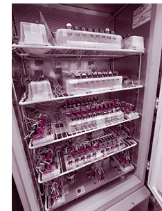
温度を一定に保った恒温槽で電池の性能試験を行う。200個程度の電池がずらっと並ぶ。
