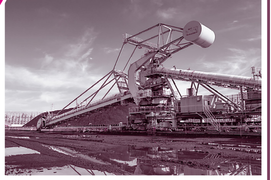
石炭を貯めておく貯炭場。石炭は、オーストラリアやインドネシア、ロシアなどから船で運んでくる。ここからベルトコンベアでボイラーに運ばれる。
