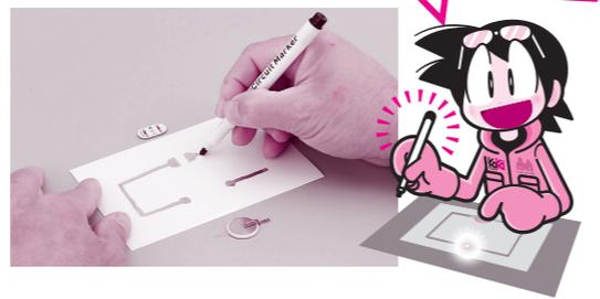
て、印刷すると紙の表面に塗られた薬品と化学反応を起こし、電気を通すようになるのです。そのため、印刷するだけで電気の回路ができてしまいます。
