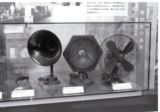
大正～昭和初期の家電製品。(左から)電気アイロン、国産ラジオ用スピーカー、初期のヒーター、扇風機。初期の電気アイロンは、プラグを抜いたり差したりして温度調節をしていた!
