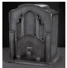
国産バッテリー真空管ラジオ。真空管を4本使用したこと(右)から「並四ラジオ」と呼ばれた。
