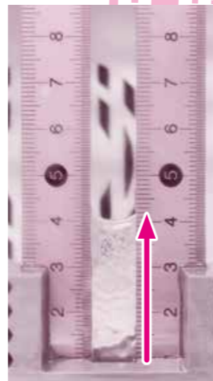
強誘電性流体で満たされたモーターの内部
