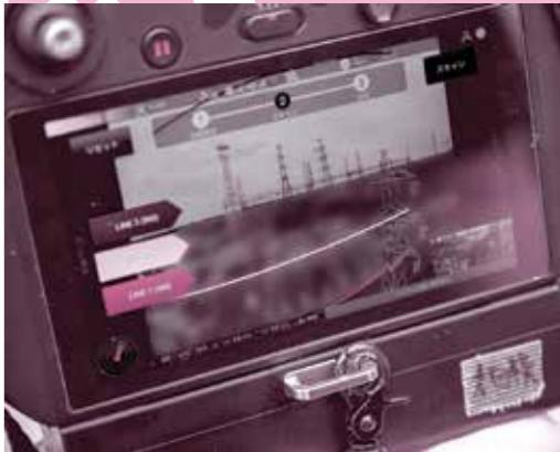
まるでゲーム機のようなドローンのコントローラー。点検する送電線を認識すると色で教えてくれる。操作はドローン任せだが、もちろん手動で動かすこともできる。
