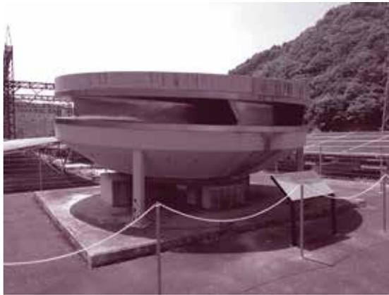
以前に使用されていたポンプ水車が、発電所の敷地の中に展示されている。直径が約5mある。実際には、垂直の軸に取り付けられていて、電気をつくるときは横から水が入り、下へ水が出ていく過程で回転するしくみだ。(写真提供：関西電力株式会社)
