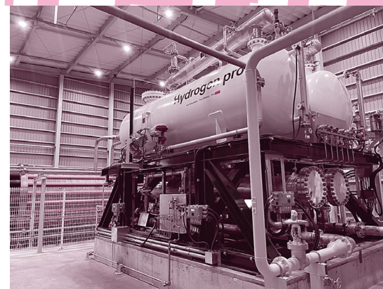
発生した気体を入れるタンクが2つ。酸素と水素が分かれて発生するので、別々のタンクに入れることができる。(写真提供／三菱重工業株式会社)
