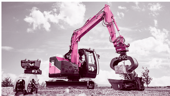
ZE85のアームの先端の部品をつけかえることで、ものをすくい上げたり、はさんだりと、さまざまな作業を1台でこなすことができる。しかも、部品の交換作業は運転手がたった1人で、座席に座ったままできるのだ。(写真提供／日立建機株式会社)
