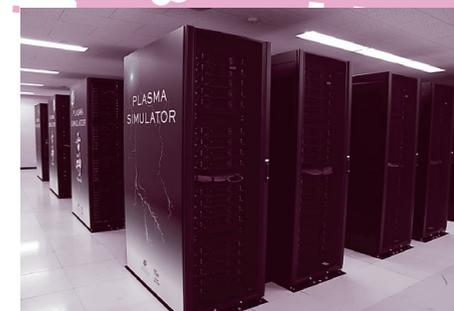
スーパーコンピュータ「プラズマシミュレータ雷神」は、プラズマの複雑な動きを詳しく調べたり、予測したりするのに欠かせない装置だ。1秒間に1京500兆回の計算ができる。「京」は「兆」の1つ上の位、1000兆の上が1京だよ。
