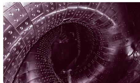
LHDが設置されている実験室の広さは縦75m、横45mで高さは40mもある。中心にすえられたLHD本体をとりまくように、真空をつくり出す装置や冷却装置、加熱装置などがすき間なくレイアウトされている（左）。LHDの内部は、大きな二重らせんのコイルが、らせん状に巻きついたりしている（上）。
