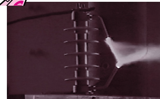
高分子がいしの耐アーク試験の様子。アーク放電(大電流放電)の際に高分子がいしが壊れないかどうかの試験をしている。(写真提供：電力中央研究所)
