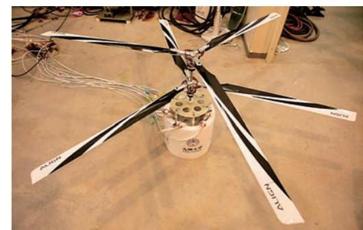
プロペラをつけた超伝導モーターのテスト機。下部の容器に超低温に保たれた超伝導モーターが内蔵されている。
