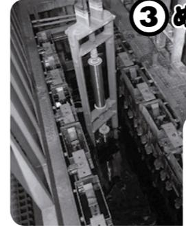
材料を取り付けたら、クレーンでつり下げて、枠ごとめっき液にひたす。
