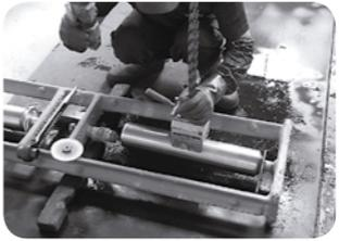
材料を枠に取り付ける。いっしょにめっきされてしまわないように、枠はプラスチックでコーティングされている。
