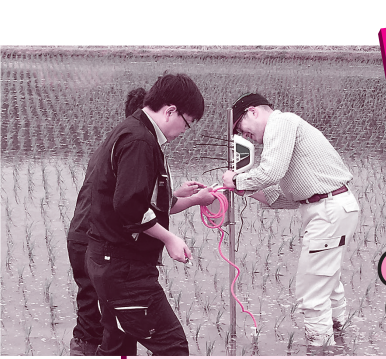
設置風景。本体とつながったセンサー部分は土の中に差し込む。(©ベジタリア株式会社)
