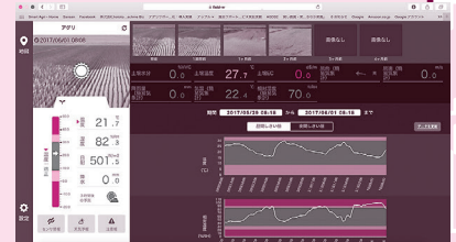
利用者に届く情報のタブレット画面。田んぼの水の深さや温度をひと目で確認できる。他にも、病気や害虫が発生しやすい環境になったことを警告する機能や、収穫時期のシミュレーション情報などを利用することもできる。
