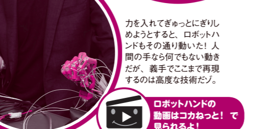
ポーズをきめるロボットハンド。本体はプラスチックでできていて、ワイヤーによって操り人形のように指を細かく動かすしくみになっている。
